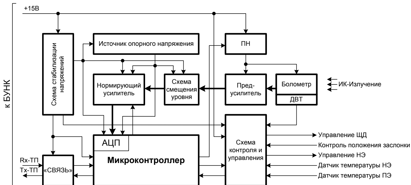
Рисунок 1.2 Структурная схема модуля управления камерой.
